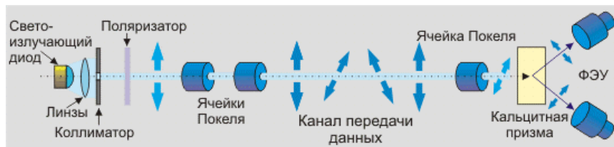
Рис. 1. Схема практической реализации квантовой криптографии
