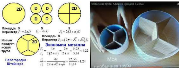
Рис.2. Новая необычная труба с перегородкой Штейнера
