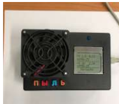
Рис. 1. Программно-аппаратный тренажер по изучению запыленности воздуха
