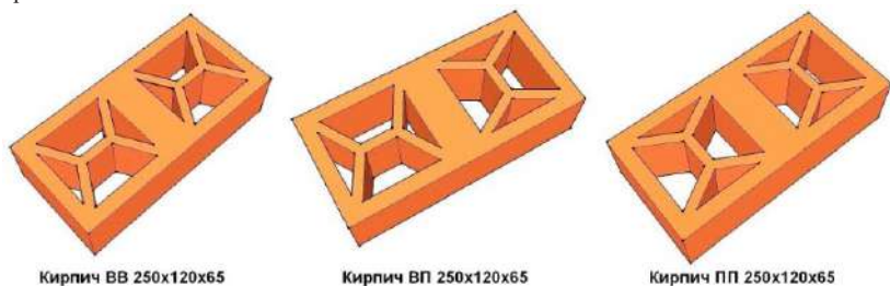
Рис.1. Три основных типоразмера нового пустотелого кирпича
