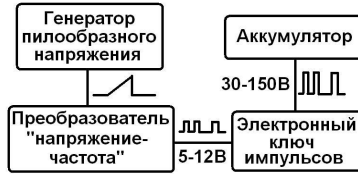
Рис.2. Блок-схема нового десульфатора
