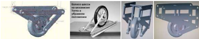
Рис.3. Сравнение компьютерной и натурной моделей механизма
