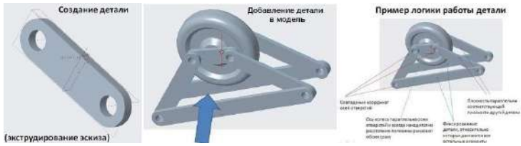
Рис.2. Процесс создания модели в среде Creo parametric 4.0.
